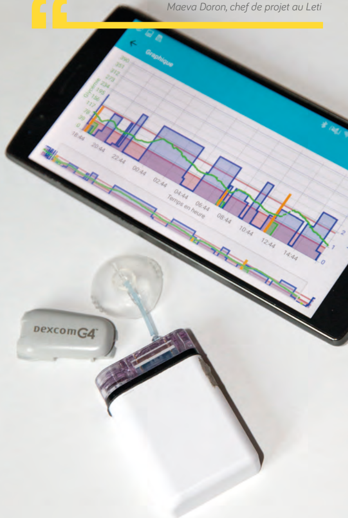
Le capteur de glycémie et la pompe-patch pilotés par l'algorithme innovant d'une application pour smartphone.
