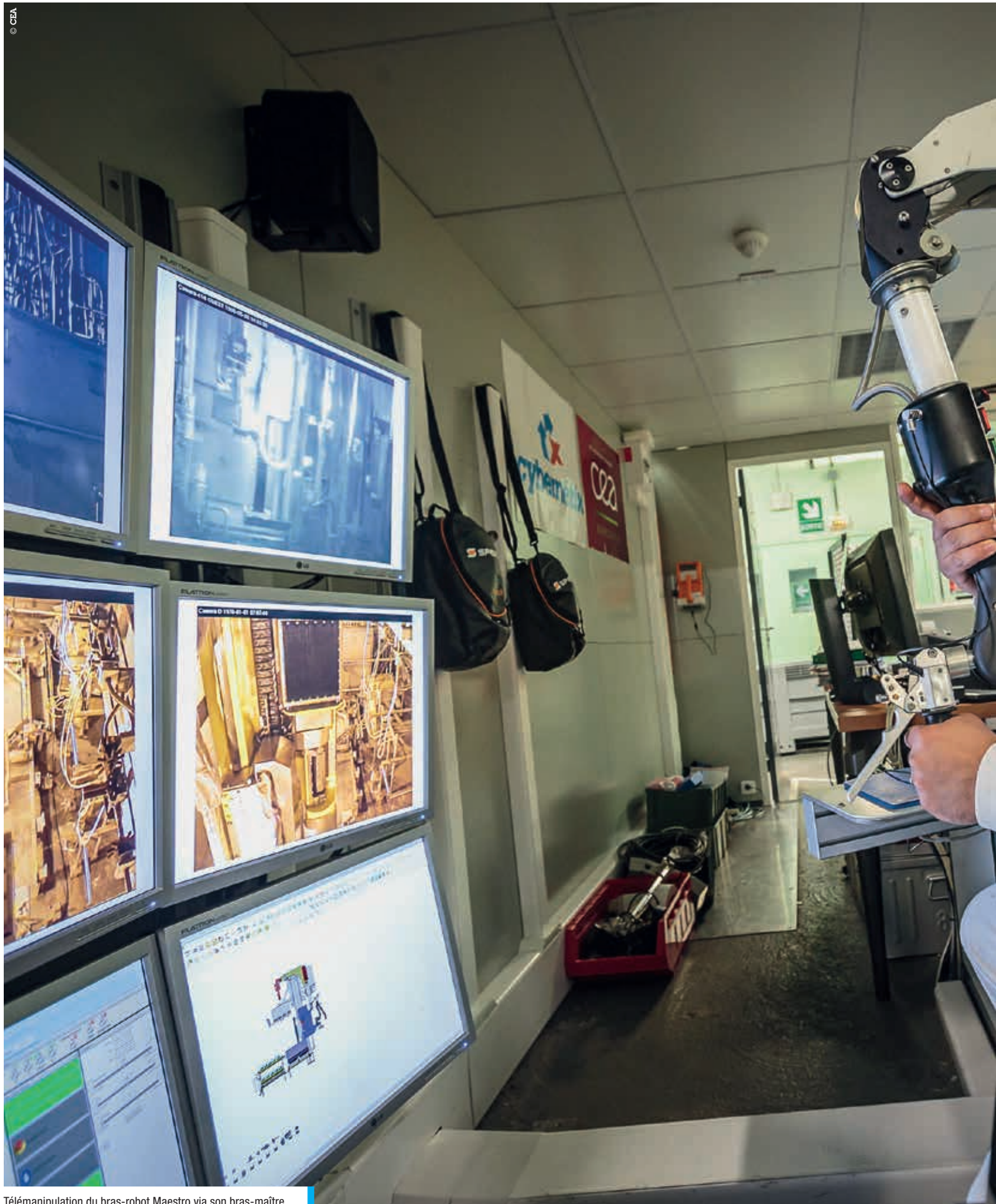
Télemanipulation du bras-robot Maestro via son bras-maître.
