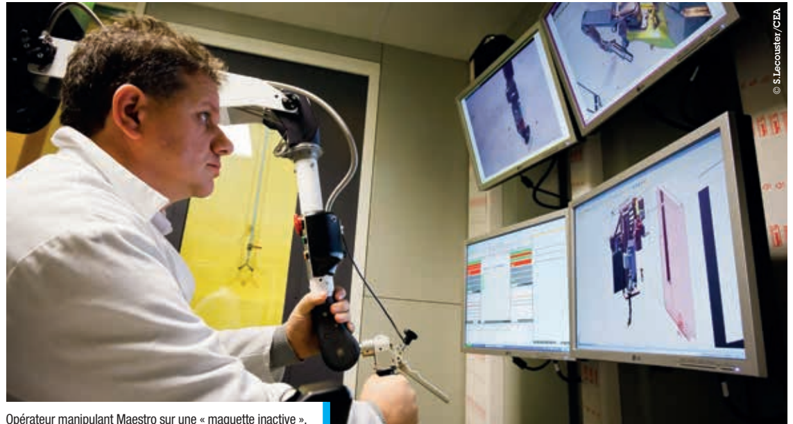
Opérateur manipulant Maestro sur une « maquette inactive ».
