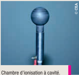
Chambre d'ionisation à cavité.
