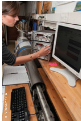
Mesures au magnétomètre cryogénique dans une chambre amagnétique.
