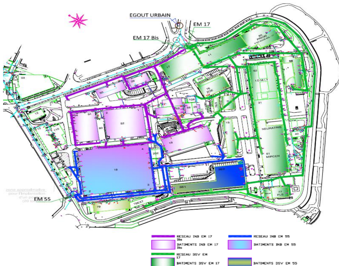
Figure 5 : Implantation des émissaires et de l'égout urbain sur le site CEA de Fontenay-aux-Roses
