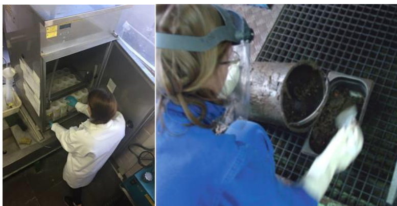
Surveillance en continu des émetteurs \gamma\beta de l'égout urbain et prélèvements de boues
