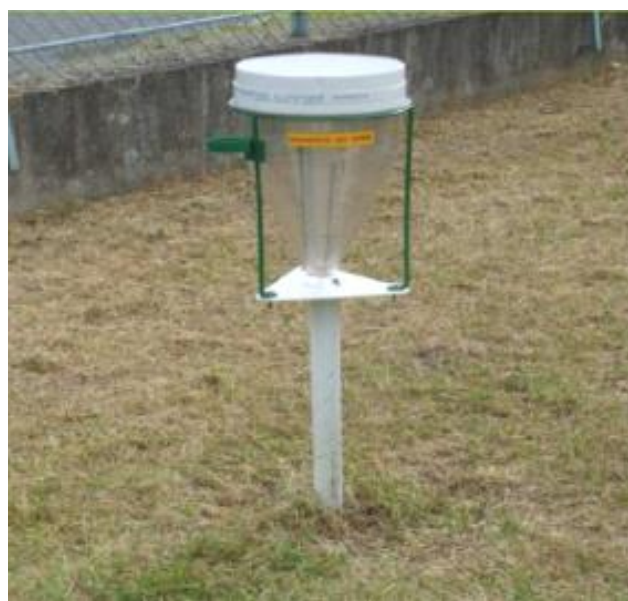
Pluviomètre 0,04 m 2 à lecture directe
