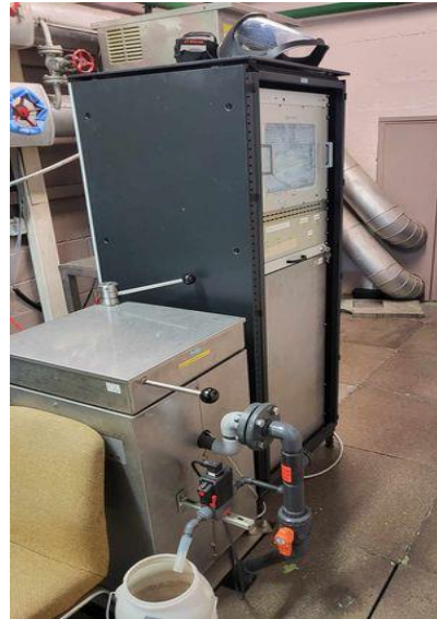
Mesures en continu de spectrométrie gamma aux émissaires EU, 17 et 17bis
