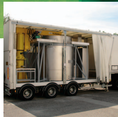
Citerne servant au transport d'effluent.
