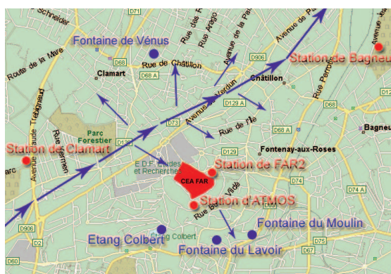
Figure n° 2 : implantation des stations de contrôle de l'environnement (les flèches bleues indiquent la direction d'écoulement de la nappe phréatique).
