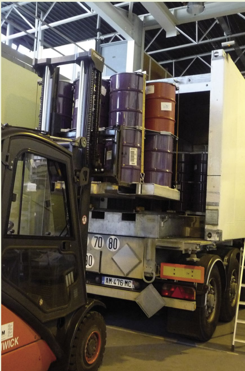
Évacuation de fûts MI (Moyennement Irradiants).
